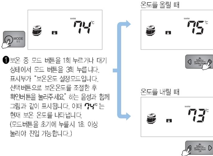
① 보온 중 모드 버튼을 1회 누르거나 대기 상태에서 모드 버튼을 3회 누릅니다. 표시부가 "보온온도 설정모드입니다. 선택버튼으로 보온온도를 조절한 후 확인버튼을 눌러주세요" 하는 음성과 함께 그림과 같이 표시됩니다. 이때 74°C는 현재 보온 온도를 나타냅니다. (모드버튼을 초기에 누를시 1초 이상 눌러야 진입 가능합니다.)
