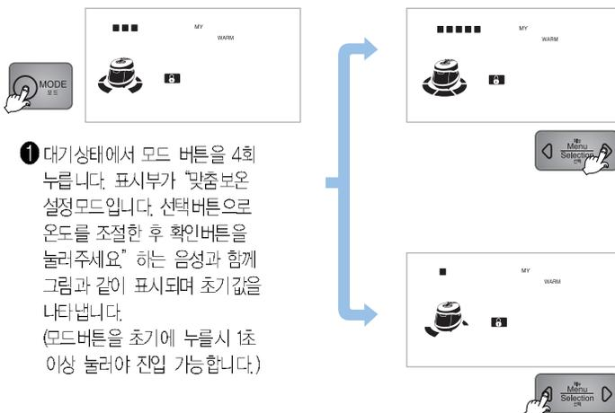
① 대기상태에서 모드 버튼을 4회 누릅니다. 표시부가 "맞춤보온 설정모드입니다. 선택버튼으로 온도를 조절한 후 확인버튼을 눌러주세요" 하는 음성과 함께 그림과 같이 표시되며 초기값을 나타냅니다. (모드버튼을 초기에 누를시 1초 이상 눌러야 진입 가능합니다.)
