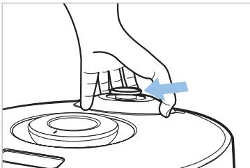
▶如图所示，用手抓住蒸汽帽凹槽部位，转向一边后，轻轻向上提起，即可卸下。
